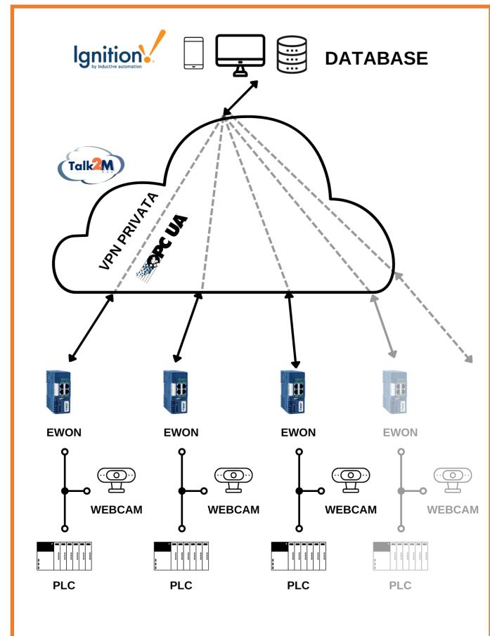
La flessibilità dell'architettura basata su Ignition ed Ewon Flexy permette di gestire il sistema modularmente e di espanderlo senza vincoli strutturali. Gli evidenti benefici che si riscontrano stanno infatti portando al continuo aggiornamento del sistema, che via via cresce come numero dispositivi interconnessi e di tag.
