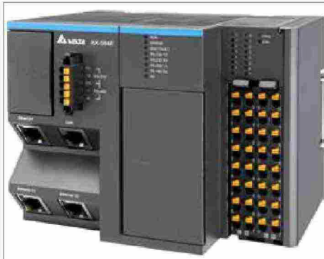
Un controller di movimento con funzionalità PLC modello AX-564E di Delta
