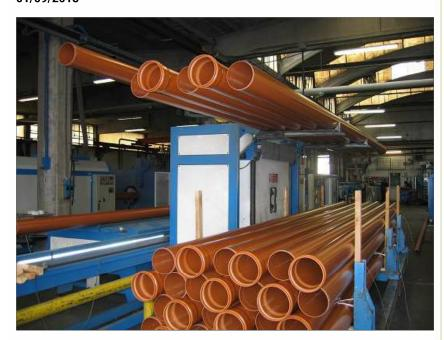
Resin Plast produce tubi e raccordi in PVC per il settore edilizio. In oltre 60 anni di attività, lo stabilimento si è ampliato e modernizzato fino a raggiungere un'estensione di circa 30.000 metri quadrati e una produzione di 11.000 t annue.
