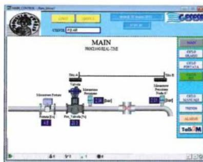
**Una schermata del sistema di telecontrollo in tempo reale della rete idrica e, in particolare, delle pressioni nelle tubature.**
