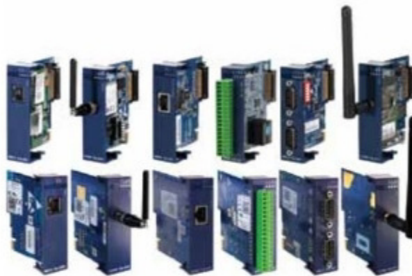
eWON Flexy 205, il gateway IIoT prodotto da HMS Industrial Networks per le specifiche esigenze di raccolta dati da remoto dispone di moduli seriali, USB, DI/O, AI/O, 3G/4G, Ethernet WAN
