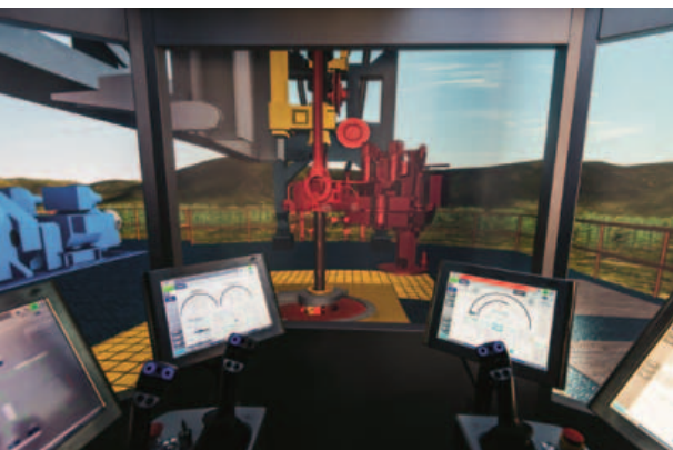
Il simulatore di perforazione per l’addestramento del personale sul campo
